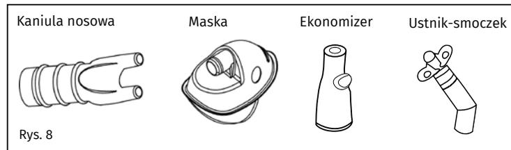
Za pomocą urządzenia do regulacji dopływu powietrza (ekonomizera) można kontrolować zużycie powietrza, a także zmniejszyć zużycie leku podczas przerw w pracy nebulizatora. (Rysunek 8).
